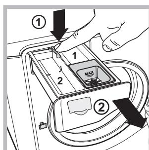
Pentru a scoate sertarul, apăsați pe levierul (1) și trageți-l spre exterior (2) (vezi figura).
