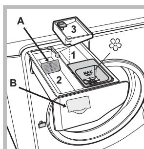
1. vaschetta per il prelavaggio: usare detersivo in polvere.
