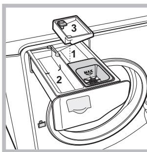
Această funcție este utilă pentru a elimina petele rezistente. Poate fi utilizată cu sau fără decolorant. Dacă se dorește și efectuarea înălbirii introduceți recipientul auxiliar 3, din dotare, în recipientul 1. La dozarea decolorantului, nu depășiți nivelul "max" indicat pe pivotul central (a se vedea figura). Dacă se
