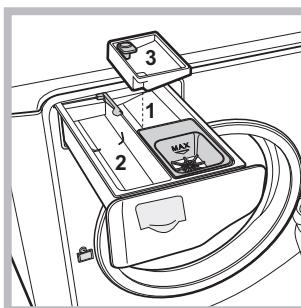
para eliminar as manchas mais resistentes. Pode ser utilizada **com** ou **sem** lixívia. Se desejar efectuar também o alvejo, coloque a gaveta adicional 3, fornecida, na gaveta 1. Quando deitar a água de javel, não ultrapasse o nível "máx" indicado no pino central (veja a figura).
