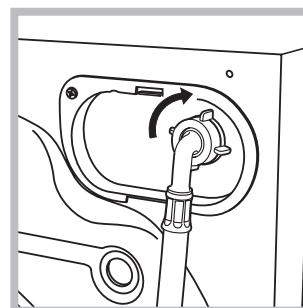
1. Racordați furtunul de alimentare la mașina de spălat, înșurubându-l la priza de apă, în partea posterioară, sus în dreapta (a se vedea figura).
