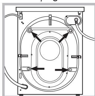
3. Închideți orificiile cu dopurile din plastic din pungă.
