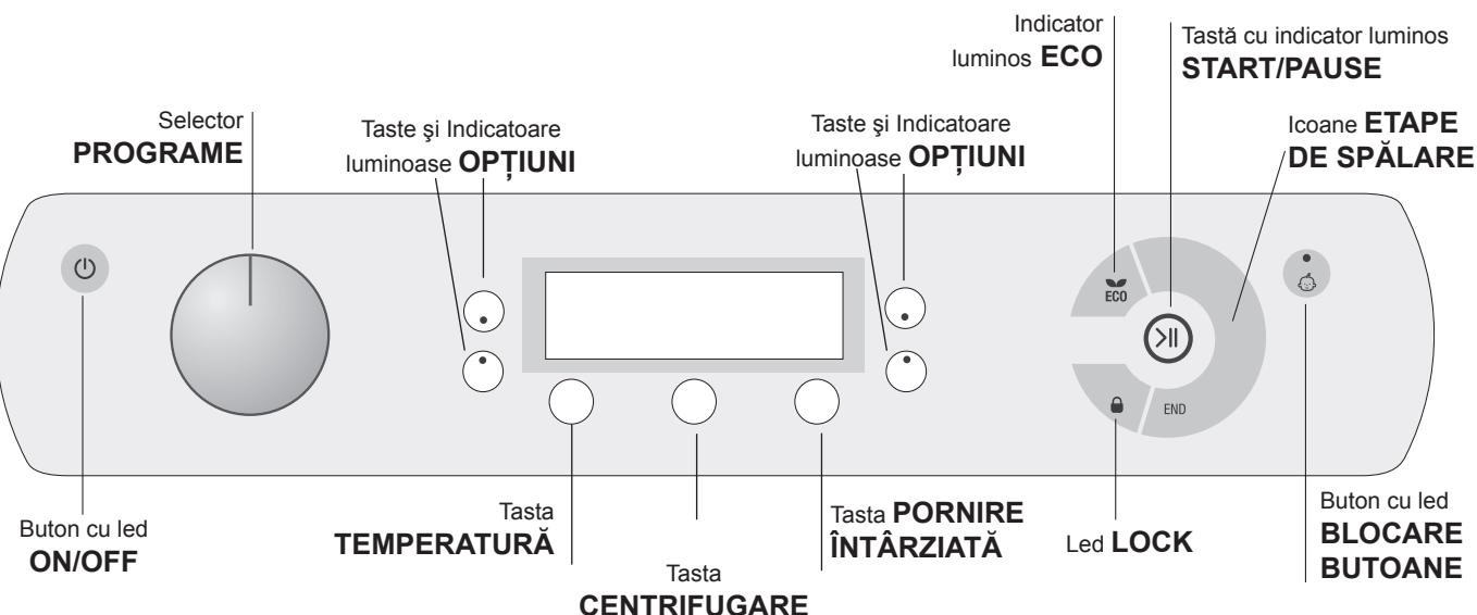
**Buton cu led ON/OFF:** apăsați scurt butonul pentru a porni sau opri mașina de spălat. Ledul verde vă arată că mașina este în funcțiuie. Pentru a opri funcționarea mașinii de spălat în timpul spălării, este necesar să țineți apăsată tasta circa 3 secunde; o apăsare de scurtă durată sau accidentală nu va opri mașina. Oprirea mașinii de spălat în timpul executării unui ciclu va anula programul în curs de desfășurare.
