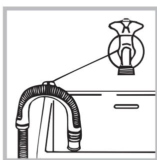
Em alternativa, coloque na beira de um lavabo ou de uma banheira, prendendo na torneira a guia fornecida com o produto (veja a figura). A ponta solta do tubo de descarga não deve permanecer
