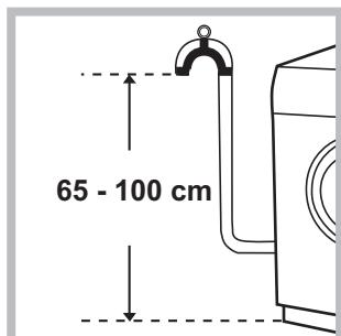
Collegare il tubo di scarico a una condutture di scarico o a uno scarico a muro posti tra 65 e 100 cm da terra evitando assolutamente di piegarlo.
