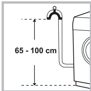
Conectați furtunul de golire a apei la canalizare sau la un robinet de golire pus pe perete, la o distanță de 65-100 cm de la pământ, evitând îndoirea sa.;
