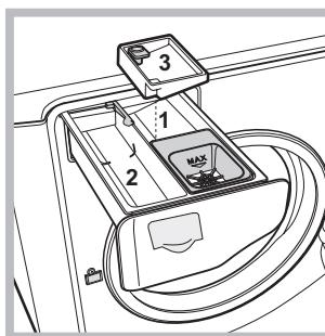
При заливе отбеливателя не превышайте "макс." уровень, указанный на стержне в центре (см. схему). Для выполнения только отбеливания без полного цикла стирки залейте отбеливатель в дополнительный дозатор 3, выберите программу «Полоскание» и включите дополнительную функцию "Суперстирка" .
