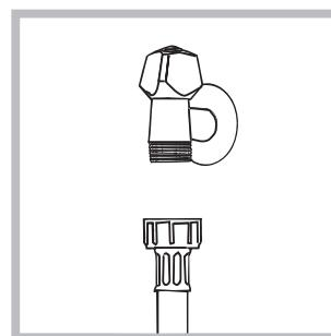
2. Conectați tubul de alimentare, înșurubându-l la un robinet de apă rece cu gura filetată de l' gaz (a se vedea figura).
