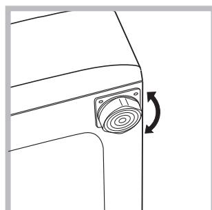
2. Compense as irregularidades desatarraxando ou atarraxando os pés até que a máquina esteja nivelada horizontalmente (não deve ter uma inclinação superior aos 2 graus).
