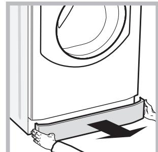
1. Îndepărtați panoul de acoperire de pe latura anteroară a mașinii, apăsând spre centru, apoi împingeți în jos de pe ambele laturi și scoateți-l (a se vedea figura).
