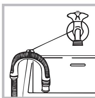
In alternativa, appoggiare il tubo di scarico al bordo di un lavandino o di una vasca, legando la guida in dotazione al rubinetto (*vedi figura*). L'estremità libera del tubo di scarico non deve rimanere
