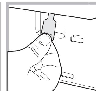
3. rimuovere il pannello di copertura sul lato anteriore della lavabiancheria con l'aiuto di un giravite (vedi figura).
