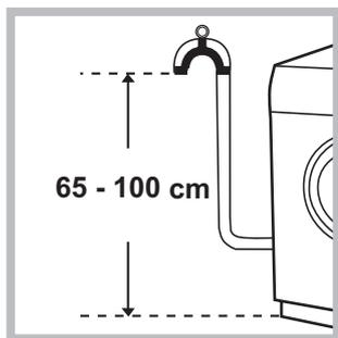
Collegare il tubo di scarico, senza piegarlo, a una condotta di scarico o a uno scarico a muro posti tra 65 e 100 cm da terra;
