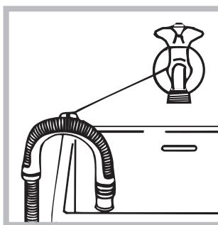
oppure appoggiarlo al bordo di un lavandino o di una vasca, legando la guida in dotazione al rubinetto (*vedi figura*). L'estremità libera del tubo di scarico non deve rimanere immersa nell'acqua.
