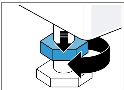
2. Per livellare l'apparecchio, ruotare i piedini dell'apparecchio. Controllare il livellamento dell'apparecchio con una livella a bolla d'aria.
