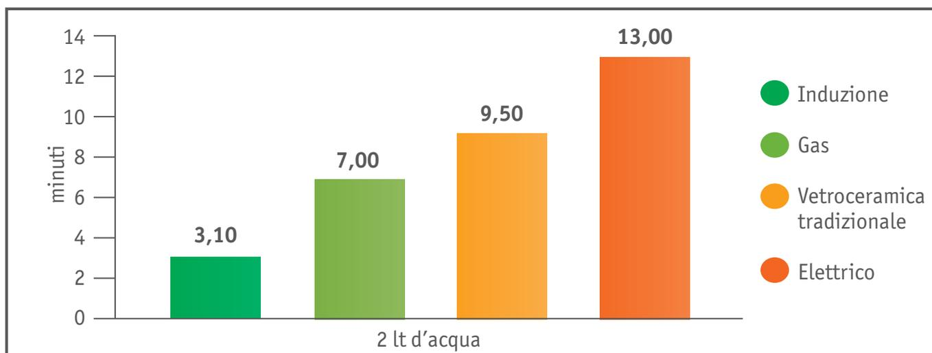
**INDUZIONE: tempo necessario per portare l'acqua da 20°C a 95°C**
